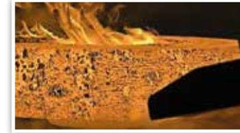
„Jedes Haus ist nur so gut wie das Fundament, auf dem es erstellt wurde“. Darum werden alle Schmiederäder bei ProLine ausschließlich aus geschmiedetem hochfestem und leichtem Aluminium „Forged in Germany“ gefertigt. Schmieden ist ein nicht zerspanendes Umformverfahren im warmen festen Zustand. Die sog. „Rohlinge“ sind Aluminium-Zylinder mit etwa 30cm Durchmesser und 60cm Höhe.
