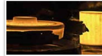
Beim Schmieden wird eine siliziumfreie Aluminiumlegierung verwendet, dadurch ist ein Polieren der Oberfläche zu einer extrem glänzenden hellen Oberfläche möglich. Dieser Glanz geht durch eine Acryllackversiegelung nicht verloren, wird aber gegen Umwelteinflüsse und Zerkratzen geschützt. Durch die Acryllackschicht ist ein Nachpolieren nicht notwendig und auch nicht möglich.
